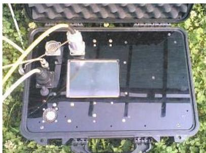
L'intero processo comprende tre passi successivi: L'acquisizione delle onde superficiali (*ground roll*), la costruzione di una curva di dispersione (il grafico della velocità di fase rispetto alla frequenza) e l'inversione della curva di dispersione per ottenere il profilo verticale delle  $V_s$ . Per ottenere un profilo  $V_s$  bisogna produrre un treno d'onde superficiali a banda larga e registrarlo minimizzando il
