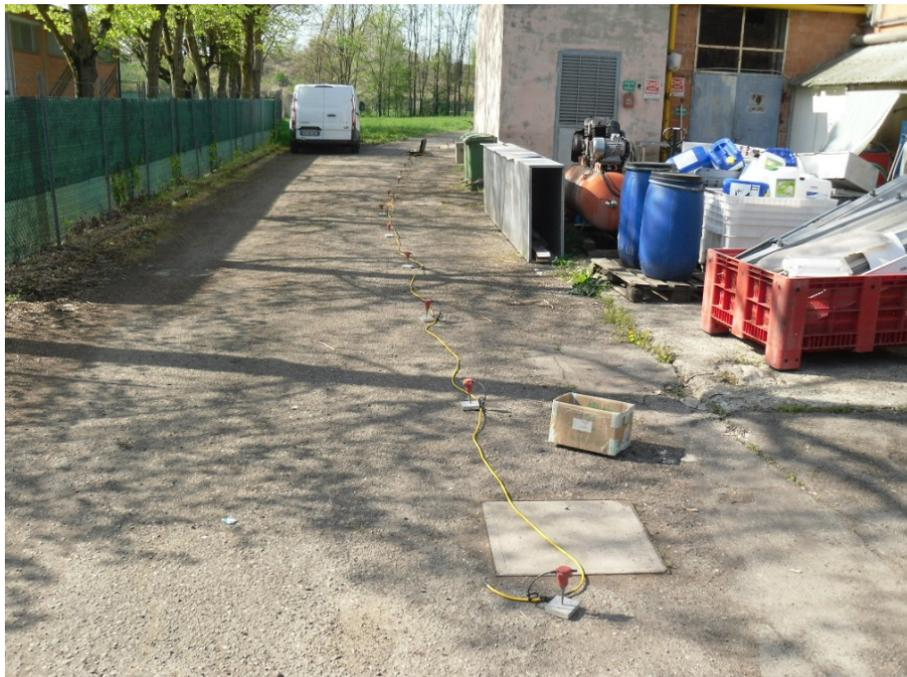
*Fig. 5: stendimento sismico zona retrostante l'Edificio B*
